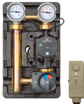
Čerpadlová skupina pre reguláciu konštantnej teploty so vstavanou elektronickou reguláciou pre podlahové kúrenie, bez nutnosti nadradenej regulácie, rozsah nastavenia 20-80 °C, DN 25, čerpadlo Grundofs Alpha 2 25-60
